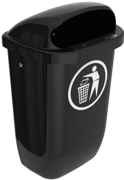
Aussenabfallsammler aus eingespritztem HDPE und rostbeständigen Metallteilen, wodurch der Behälter gegen Verrostung, Frost, Hitze und viele chemische Substanzen Stand hält. Der Deckel schützt gegen Regen und verhindert den Einwurf großen Mülls. Ausgestattet mit Edelstahlplatte am Rand, zum Zigarettenausdrücken. Einfache und saubere Entleerung mittels Dreikantschloß im Deckel. Zur Wand- oder Pfahlmontage geeignet.
