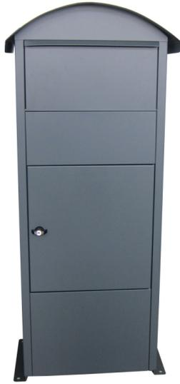
Robuster freistehender Briefkasten aus pulverbeschichtetem verzinkten Stahl. Die große Einwurföffnung (36 x 17 cm) befindet sich hinter einer Klappe. Geeignet für größere Postsendungen und Päckchen. Die Post fällt beim Schließen der Klappe ein Fach tiefer in die große Box, die durch ein Zylinderschloss verschlossen ist. Bodenbefestigungsmaterial nicht im Lieferumfang enthalten.
